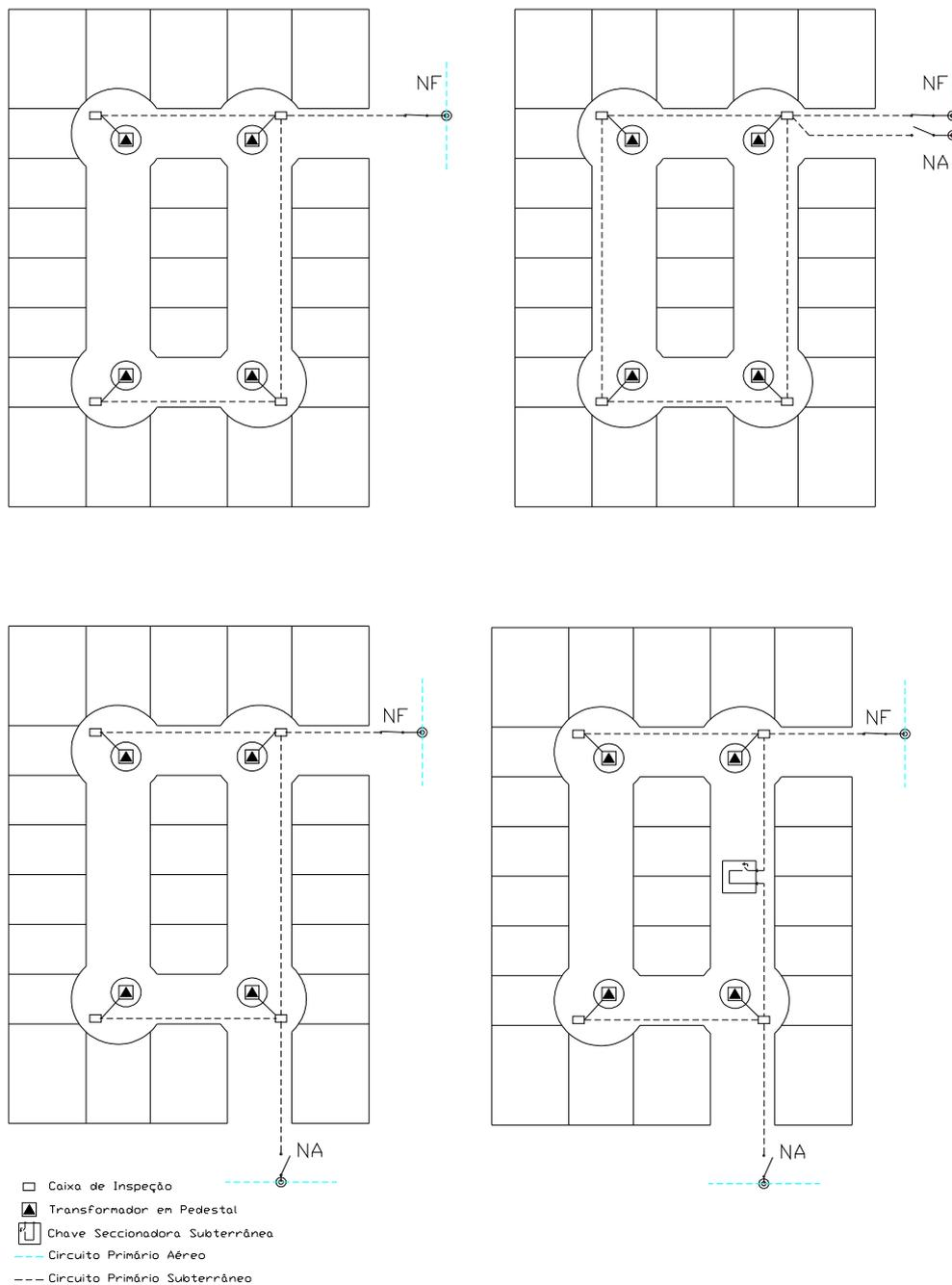
**Figura 8 – Exemplos de circuitos primários radiais.**
