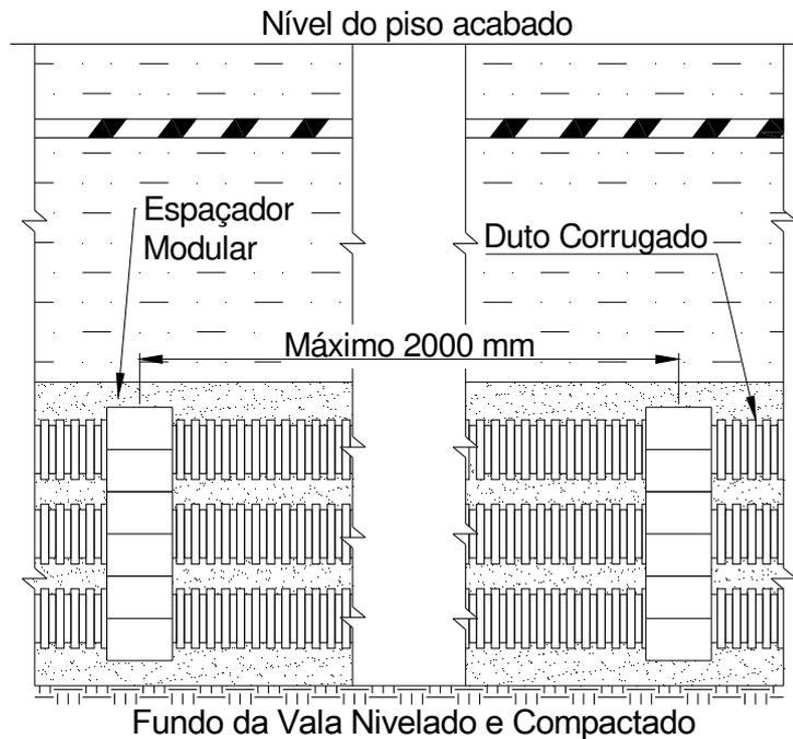
**Figura 5 – Instalação de espaçadores em bancos de dutos**
