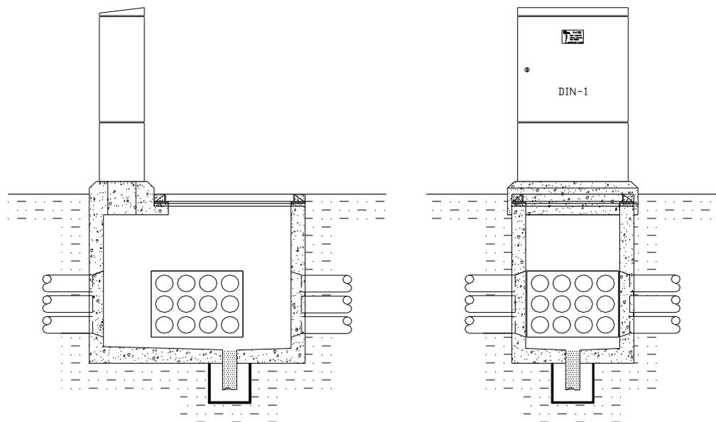
**Figura 14 – Quadro de distribuição e proteção instalado sobre base de concreto com caixa acoplada**
