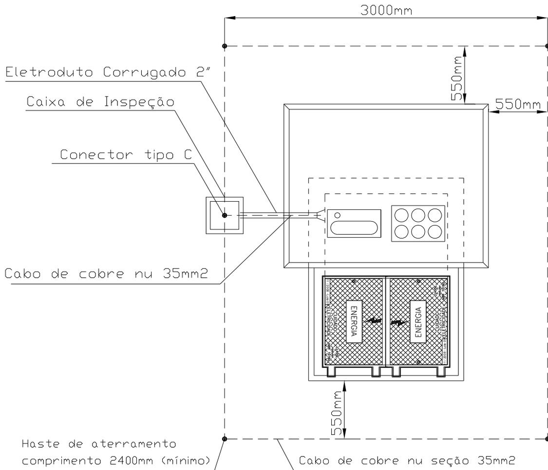
**Figura 20 - Instalação de Aterramento nos Transformadores Pedestais.**
