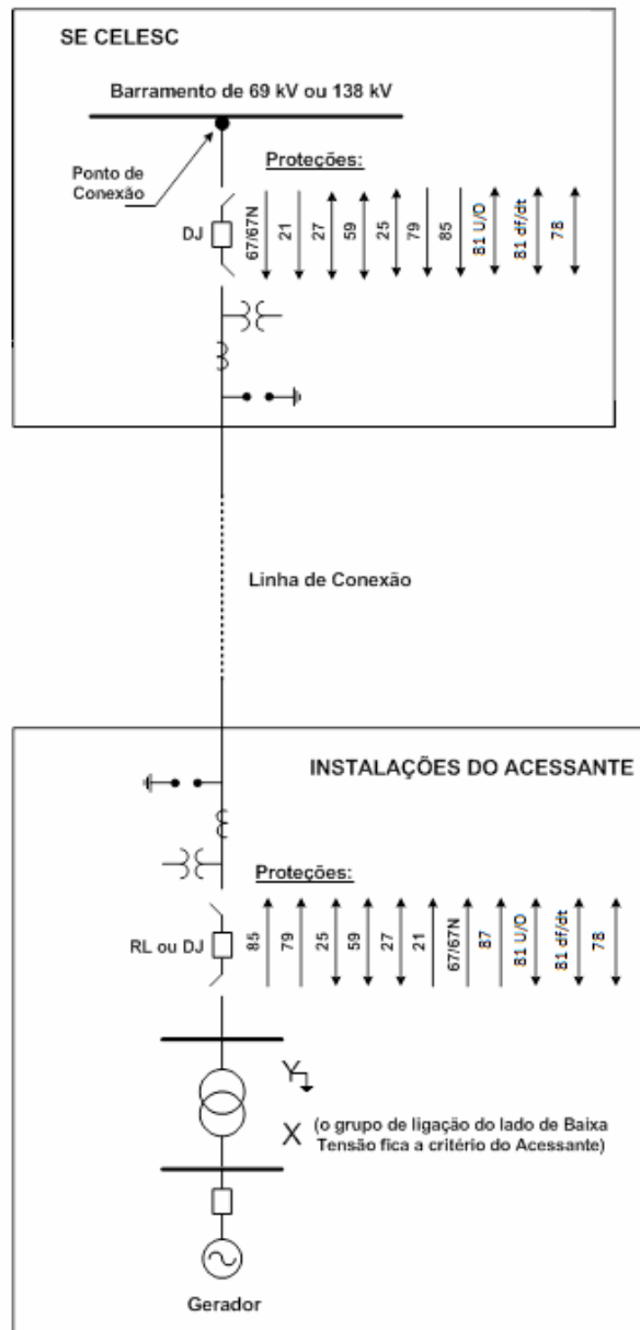
Diagrama 2: Esquema de Proteção Orientativo para Conexão em 69 kV ou 138 kV
